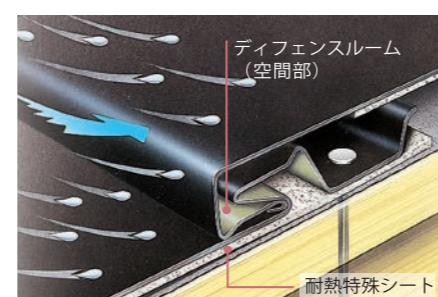
にも水滴を排出するルートを設計し、対策は万全です。防水試験では風速20メートルと30メートルの各条件下で1時間に240ミリ相当の雨をクリアし※、業界トップレベルの卓越した防水性能を実証しています。
